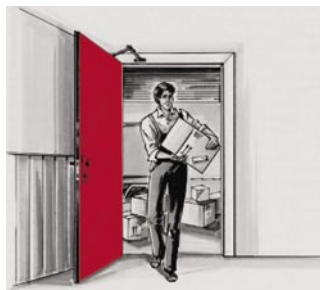
Spärruppställningsarmar får ej användas till branddörrar
