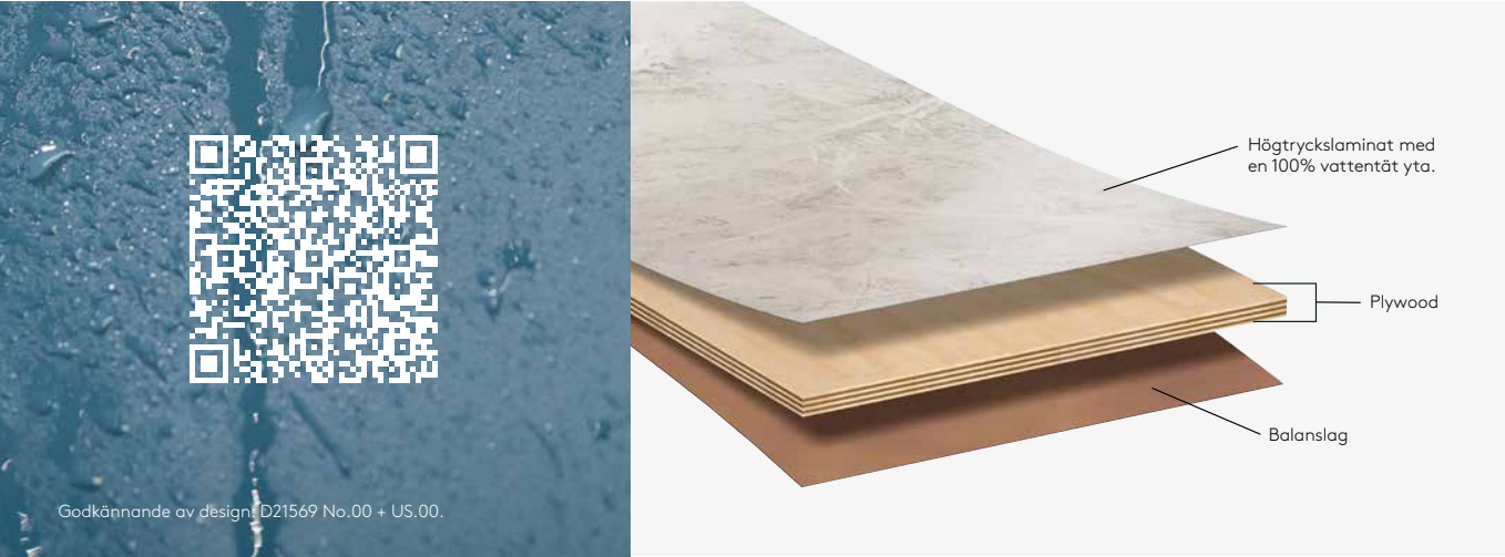
Fibo väggskivor är tillverkade med en kärna av plywood som produceras från träsorter som är PEFC-certifierade. Skivorna pressas och täcks med högtryckslaminat för att skapa membranet på framsidan. Genom att använda Fibo Seal i fogarna uppnår du en 100% vattentät och miljövänlig vägg som är anpassad efter dina behov.
